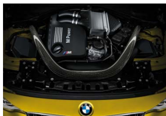
6 cylindres en ligne M TwinPower Turbo (431 ch).
